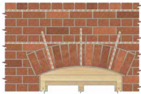
Repareren van bakstenen lateien
